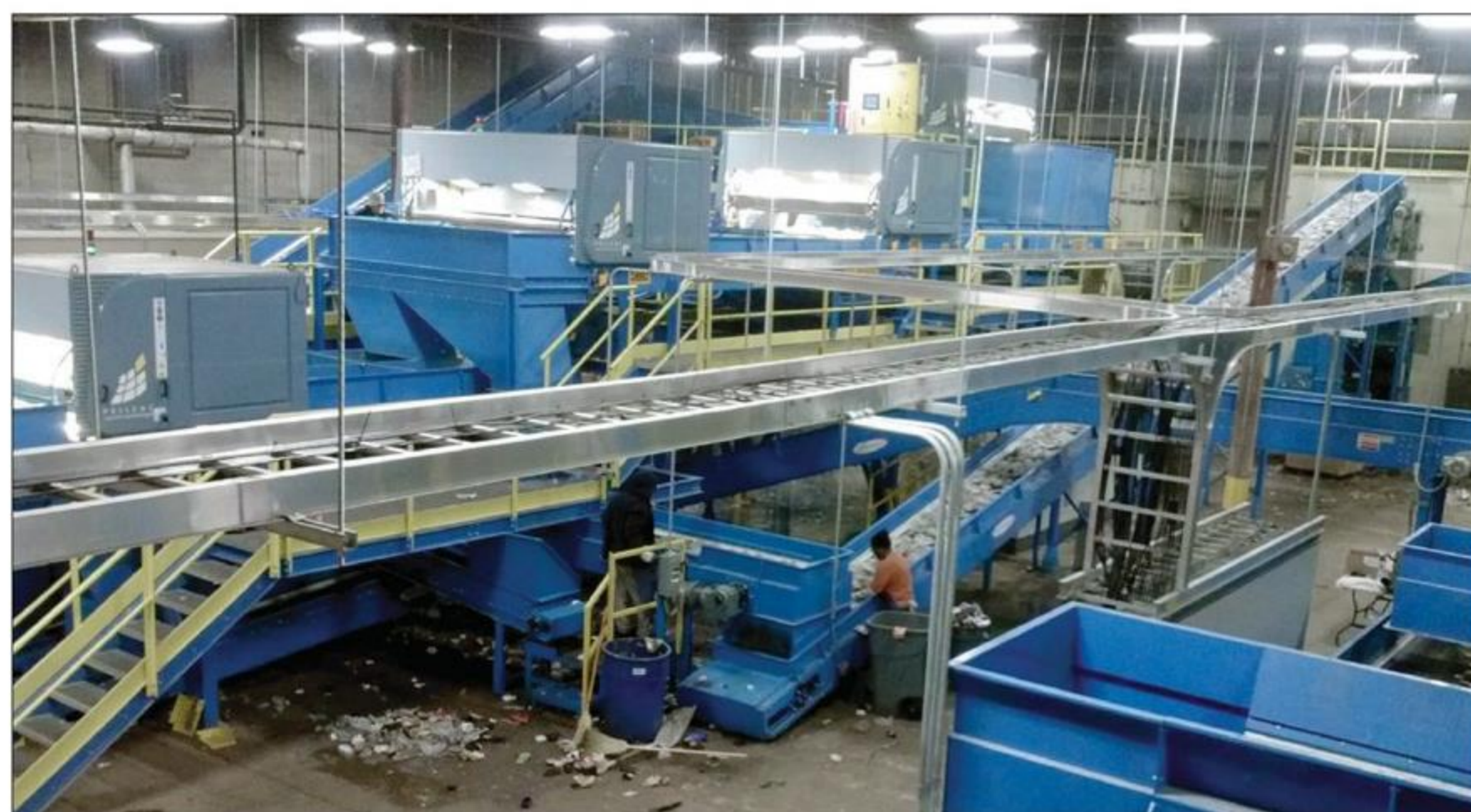
Recyclingudstyr baseret på NIR (near-infrared) fra den italienske producent Amut S.p.A.
